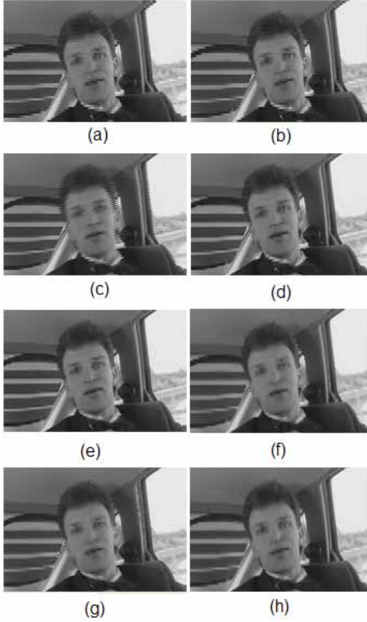
Figura 3: Imágenes desentrelazadas obtenidas aplicando: (a) RL, (b) I_S , (c) I_T , (d) VT2fields, (e) VT3fields, (f) técnica [10], (g) propuesta de 2 y (h) 3 reglas
