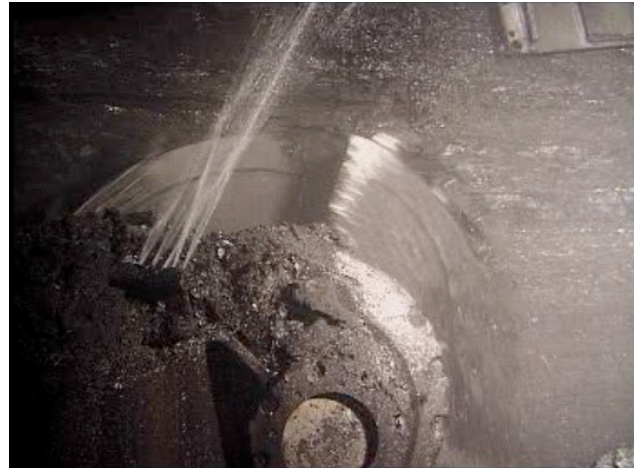
Figura #7: Rozadora actuando contra capa de carbón
