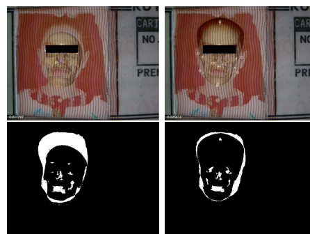
Figura 6: Caso de estudio 2. Fila superior. Mejor emparejamiento con marcadores precisos (izquierda) y difusos (derecha). Fila inferior. Imagen binaria resultante de aplicar el operador XOR sobre las imágenes del mejor emparejamiento, usando marcadores precisos (izquierda) y difusos (derecha).
