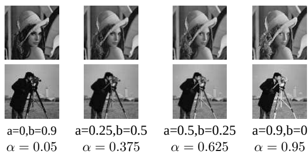
Figura 3: Reducción mediante operadores S-OWA
