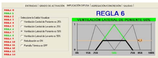
Figura 10: Implicación difusa para el controlador del invernadero.
